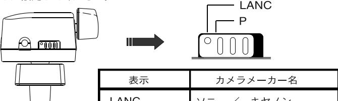
ソニー社製／キヤノン社製のカメラに接続して使用する場合
