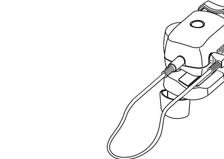
※図のようにケーブルのリモート端子を差し込んで収納してください。
